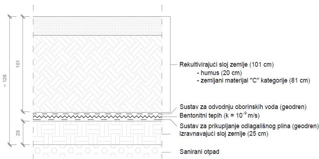
Slika 3: Završni brtveni sloj
