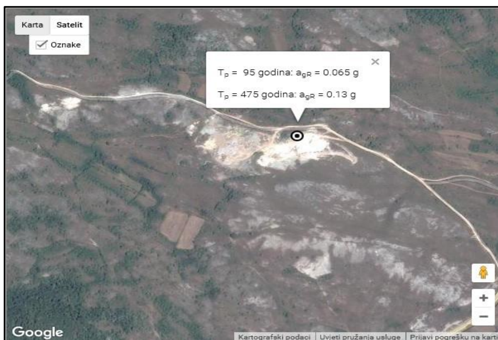
Slika 13: Vrijednost horizontalnih vršnih ubrzanja tla tipa A ( a_{gR} ) za povratna razdoblja T_p = 95 i 475 godina
